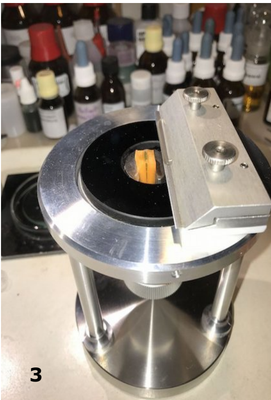
Abb. 3 – Das für die hier gezeigten Schnitte verwendete Zylindermikrotom mit eingespannter Probe und Klingenhalter.
