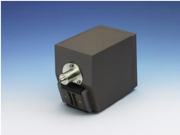
Abbildung 2: Zeiss Multichannel-Spektrometerblock (Quelle: Zeiss-Homepage, www.meditec.zeiss.de ). Links unten der Platz für das Diodenarray; der zylindrische Ansatz ist der SMA-Anschluß des Lichtleiters. Abmessungen 140 x 105 x 75 mm 3
