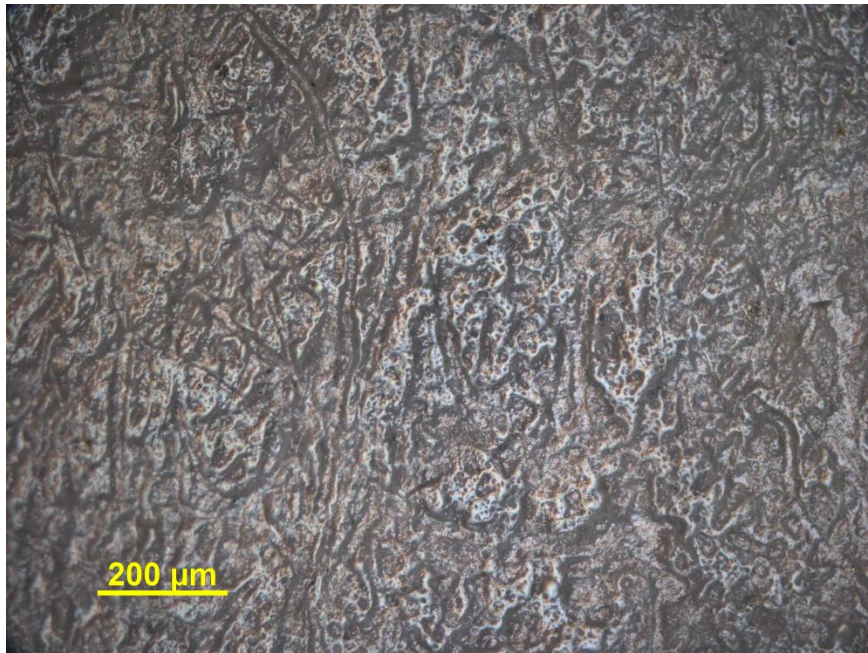
Abbildung 5: Papieroberfläche, Beschichtung (Auflicht-Hellfeld, DIK)
