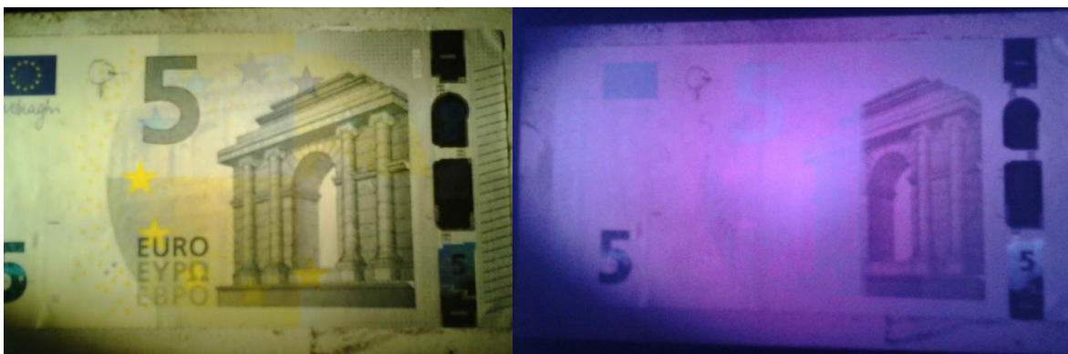
Abbildung 33: Bilder mit der Handykamera: links ohne, rechts mit Infrarotfilter
